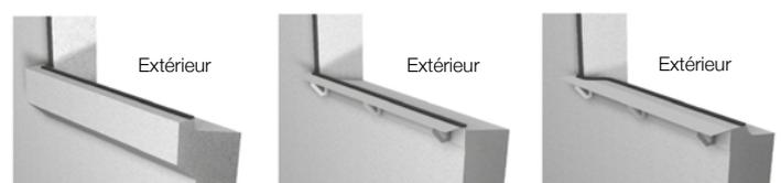
Figure 18 : Exemples de continuité du calfeutrement entre traverse basse et montant
