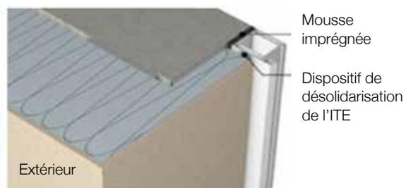
**Figure 11 : Principe de pose de mousse imprégnée en raccordement Menuiserie/ITE**
