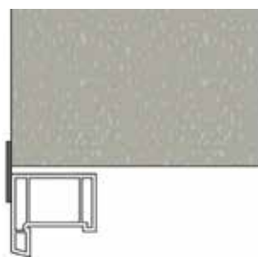
Figure 8 : Exemple de pose de menuiserie en pose tunnel au nu extérieur
