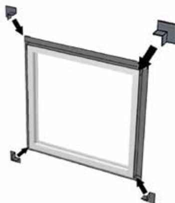
Figure 14 : Pose sur 4 côtés (avec ou sans angles préformés)
